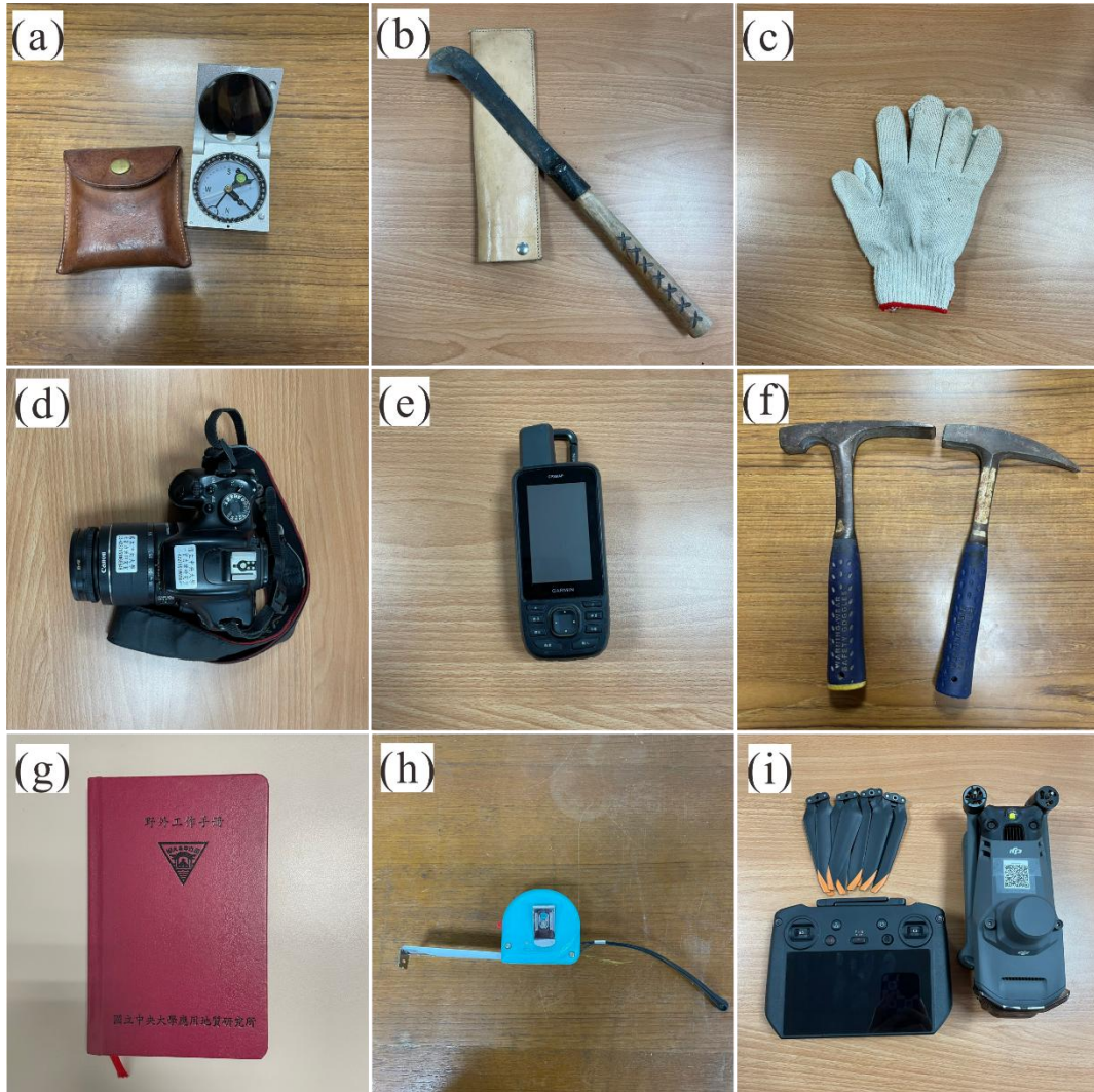
圖 3-9 野外勘查所需裝備，(a)地質羅盤；(b)開山刀；(c)布手套；(d)單眼相機；(e)GNSS 手持定位器；(f)地質鎚(左：平嘴、右：尖嘴)；(g)野外紀錄簿；(h)捲尺；(i)無人飛行載具(UAV)。
